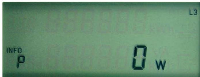
Durch eine lange Betätigung des Lichtsensors bei den unten aufgeführten Menüpunkten ist es möglich, in eine Vorwerteliste zu gelangen. Hier können Sie sich, soweit gebildet, mit kurzen Betätigungen des Lichtsensors die Vorwerte anzeigen lassen ( -1 letzter Tag bis -730).
