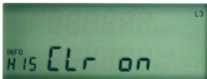
Durch eine lange Betätigung des Lichtsensors im Menüpunkt 0.2.2 können Sie die Anzeige der E-Werte in der zweiten Displayzeile deaktivieren. Um die E-Werte wieder zur Anzeige zu bringen, ist eine erneute Eingabe der PIN erforderlich.
