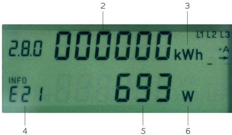
2. Für die Abrechnung relevante(r) Zählerstand/-stände
